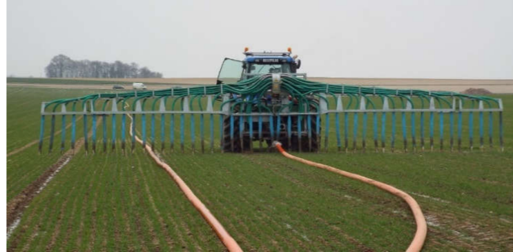
Photo : Epandage sans tonne avec une rampe à pendillards (CA02) avec reprise possible du digestat depuis une lagune ou un réseau d'irrigation.
