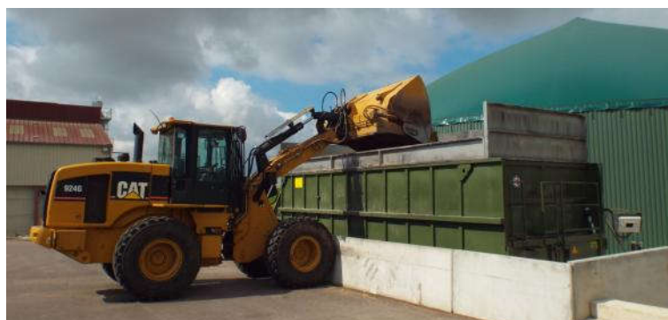
Alimentation de la trémie d'incorporation des matières solides (CA02)
